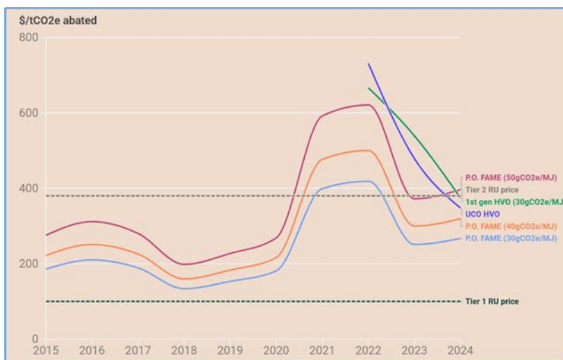
Figura 15. A análise da T&E (2025) baseia-se nos preços históricos de diferentes biocombustíveis. A análise utiliza uma intensidade de 17.25 gCO 2 e/MJ para UCO HVO e 91.39 para VLSFO. Os preços do VLSFO representam valores históricos em Roterdão.
