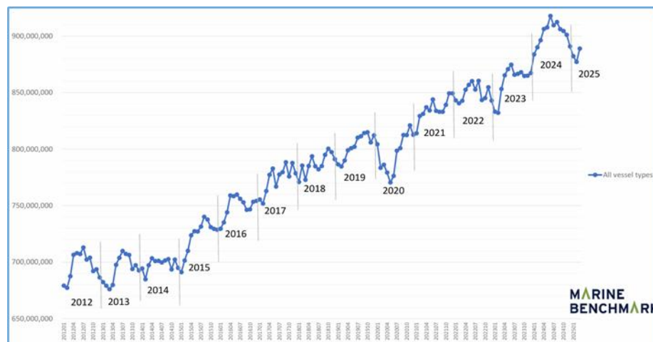
Figura 1. Emissões anuais de CO 2 da frota global de navios com número IMO, com base em dados AIS, de janeiro de 2012 a março de 2025. Fonte: S&P Global & Marine Benchmark.
